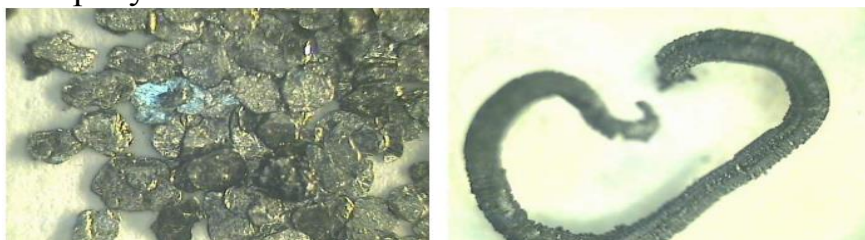
Рисунок 1. Чешуйки интеркалированного графита и «вспученный» графит.
