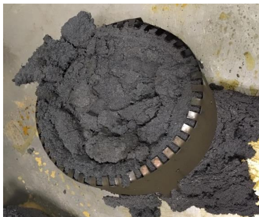
Рисунок 2. Образец муфты после испытаний.
